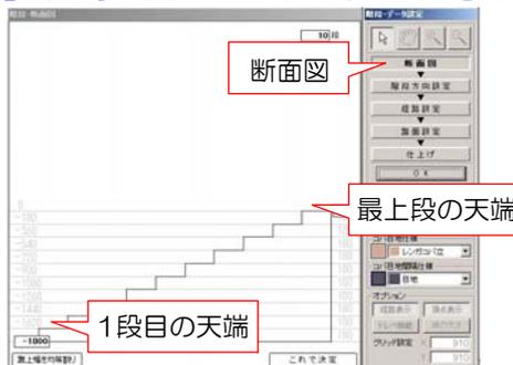
階段の断面図の部分で、1段目の天端と最上段の天端をあらかじめメモしておくこと計算しなくてもすぐに入力する事ができます。
